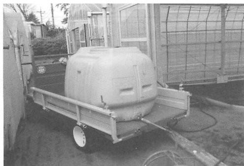
1 エタノール水溶液を積載した灌水装置
