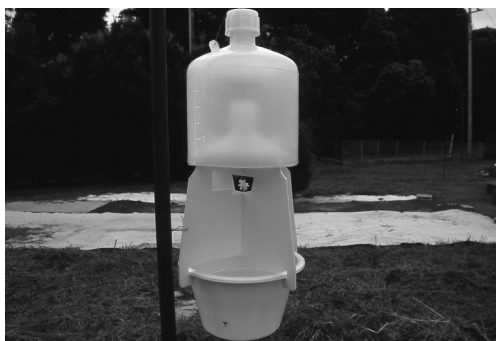
図-2 乾式トラップ試作第1号
