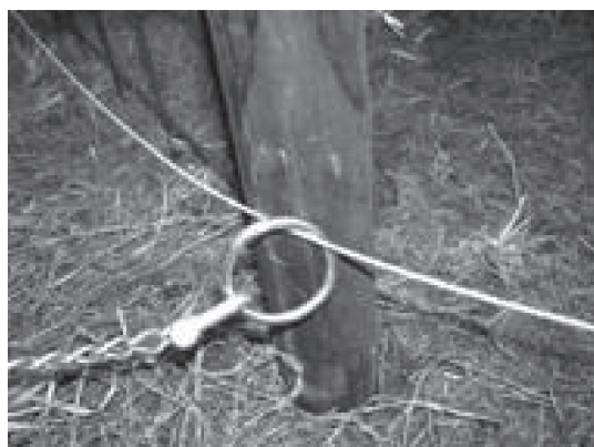
図-3 銅線とリングの連結状況
