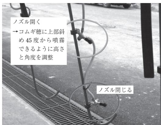
図-2 試験に用いた吊り下げ式処理装置のノズル
