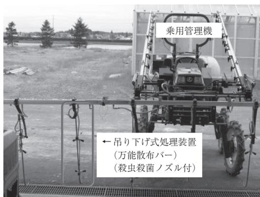
図-1 試験に用いた吊り下げ式処理装置
