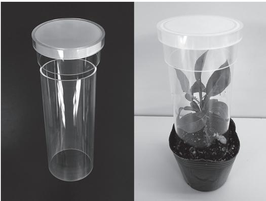
図-4 幼苗への接種吸汁用アクリル樹脂製筒状容器
