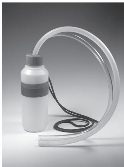
図-4 タバコカスミカメの採集に用いる吸虫管
