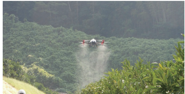
図-2 かんきつ園でのドローンによる農薬散布
