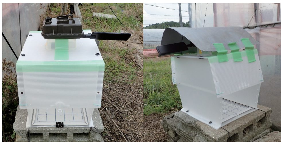
図-1 市販のIoT自動撮影カメラを市販品の部品から自作した粘着式フェロモントラップに装着して作成した「IoTカメラ付き粘着式フェロモントラップ」（右写真は雨除けカバーを付けた状態）（金子ら（2021）より関西病虫害研究会の承諾を得て転載）
