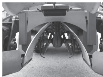
図-1 畦用マルチャ: センタードライブタイプ (駆動軸: 機体中央)
