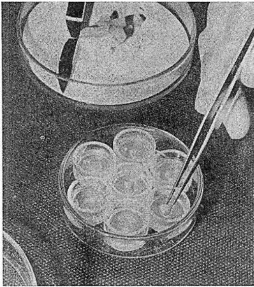
第2図 孔あきセル法 試料を設置しているところ。
