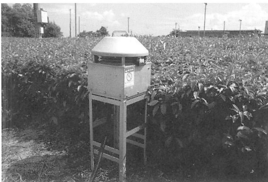
図-4 電撃型自動計数フェロモントラップ(捕獲部) 撮影のため圃場の外に設置した。通常は圃場の中に設置する。
