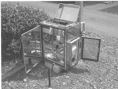
図-5 クワシロカイガラムシふ化幼虫の自動計数装置（寺田製作所）
