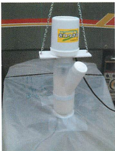
①ダクト内投入「自動投入機」(きつつき君)
