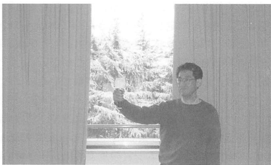
図-1 スピードガンによる計測状況
