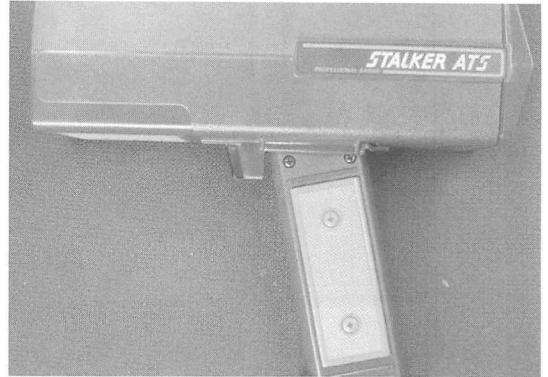
図-4 スピードガン側面 グリップ上部引き金状のボタンを押すことで計測する。
