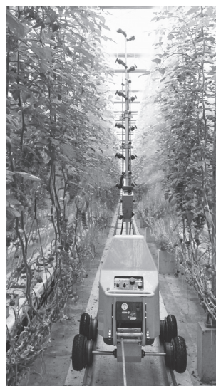
図-7 開発機による散布の様子
