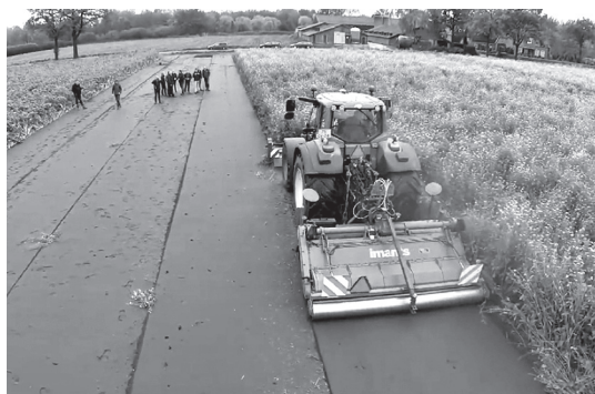
図-2 巨大な細断同時鋤き込み機（オランダ イマンツ社製）によるアブラナ科植物の鋤き込み・鎮圧 イマンツ社ホームページの動画より。
