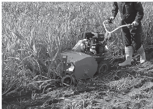
図-3 小型の細断同時鋤き込み機（試作機）による植物の細断・鋤き込み
