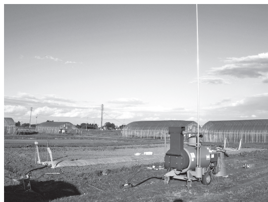
図-4 蒸気土壌消毒機(丸文製作所、型式SB-300)による 処理 畑転換圃場(3a)、1区30 m 2 (15 m×2 m)。
