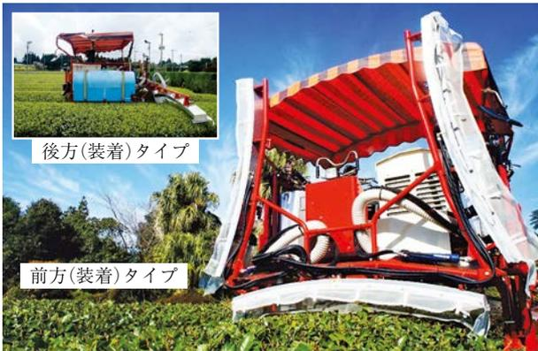
図-1 少量農薬散布機 (MCS-KAGO3-2; 松元機工株式会社製) (鹿子木, 2019 を改変)
